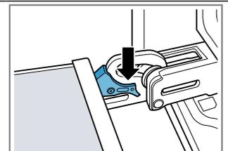
Дверца прибора зафиксирована и не может быть снята с петель.
