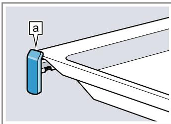
**Заметка:** В полностью выдвинутом положении направляющие фиксируются. Слегка нажмите на выдвижные направляющие при задвигании их обратно в рабочую камеру.
