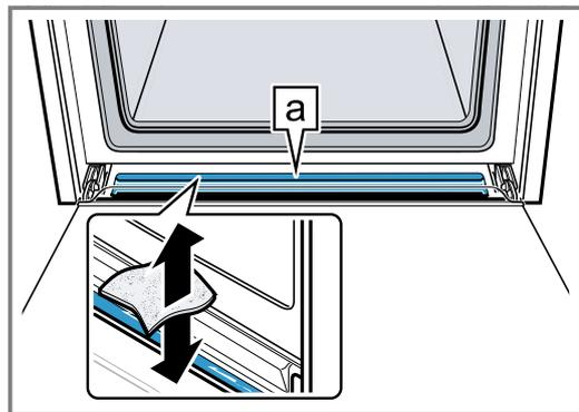
С помощью губки удалите воду из желоба для отвода конденсата **a** и аккуратно протрите его.
